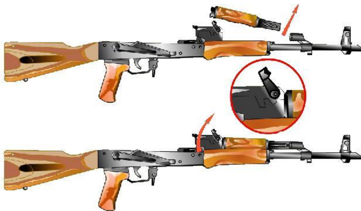
Рис. 9. Отделение газовой трубки со ствольной накладкой
